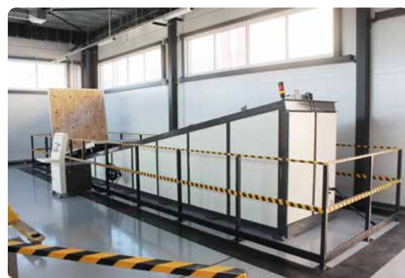
Тестирование упаковочных решений в ГП «Готэк» осуществляется в имитационных центрах, воспроизводящих условия эксплуатации
