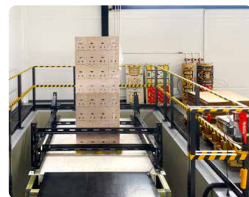
Тестирование упаковочных решений в ГП «Готэк» осуществляется в имитационных центрах, воспроизводящих условия эксплуатации
