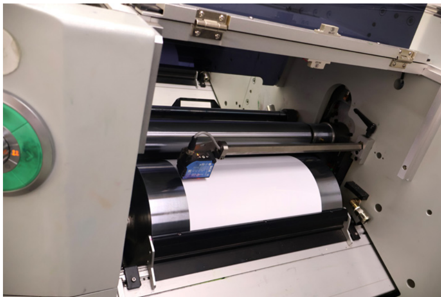
Хорошо видный на фотографии цилиндр водяного охлаждения большого диаметра даёт возможность печати на тонких тянущихся материалах, включая термоусадочные
