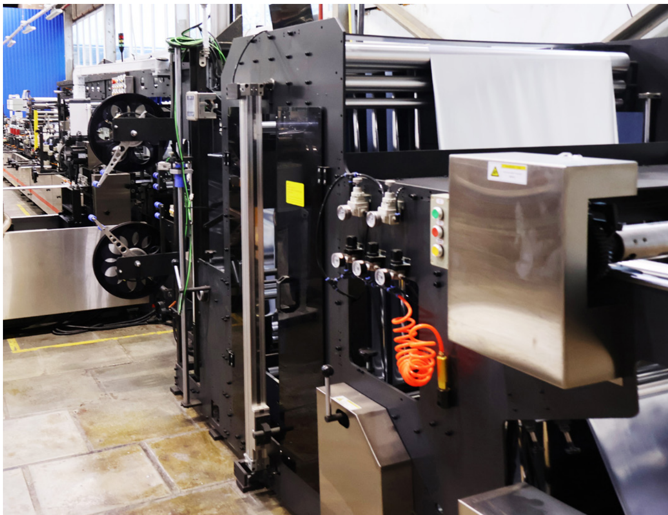
На переднем плане встроенная в машину AMD650FSL-S12 линия подачи материала, используемого для подачи бокового фальца пакета «квадросил»
