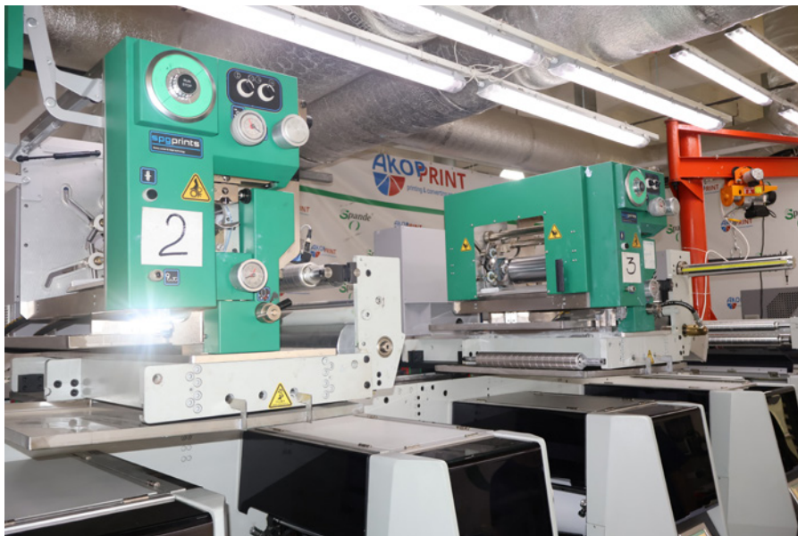
Перемещаемые по рельсовым направляющим секции трафаретной печати компании SPGPrints могут быть установлены после любой печатной секции
