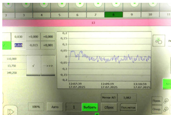
На центральном экране управления машиной (фото слева) отображается график, в реальном времени демонстрирующий степень отклонения в микрометрах совмещения цветов в конкретной печатной секции. Справа на фото — задаваемый оператором шаг корректировки точности цветового совмещения по двум координатным осям
