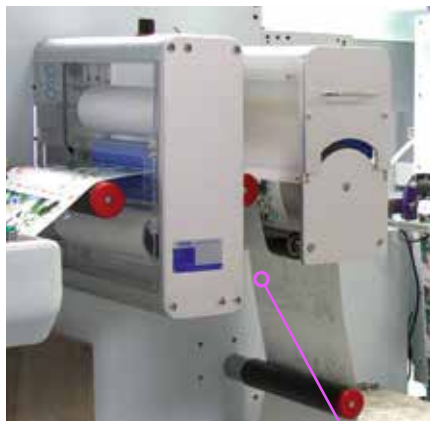
Узлы очистки полотна и обработки коронным разрядом
