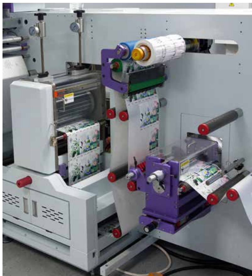
На фото слева: полуротационная высечка; узел отделения и намотки обложки Snowball; узел резки в ручьи
