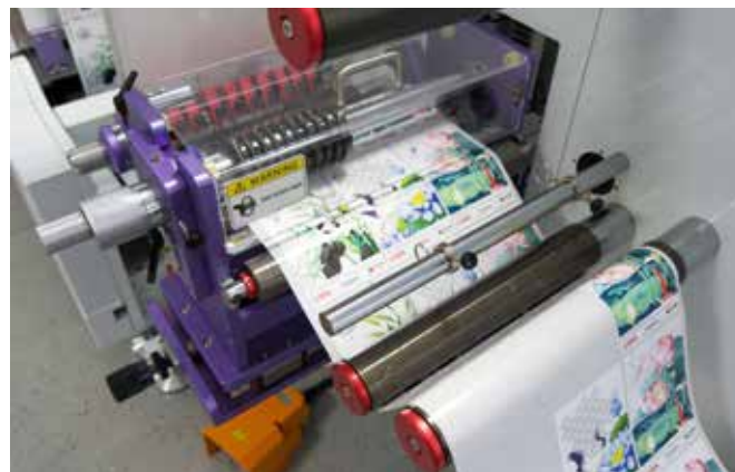
Узел резки в ручьи. Способен использовать как набор ножей (красные, в верхней части фото), так и дисковые ножницы (ниже правее). На фото внизу — общий вид узла
