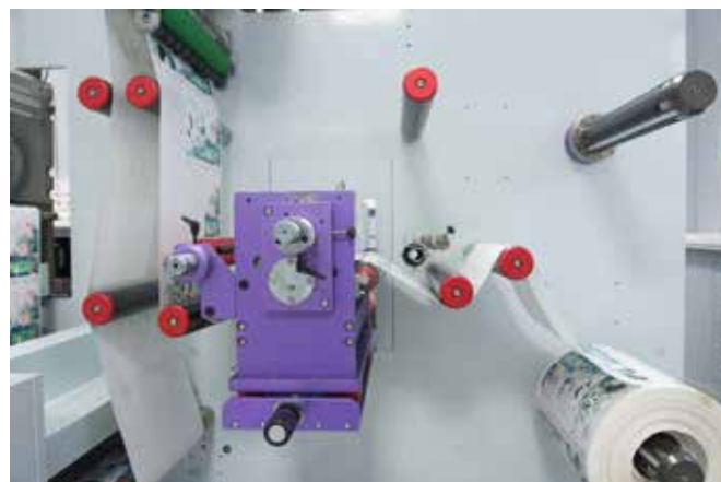
Узел резки в ручьи. Способен использовать как набор ножей (красные, в верхней части фото), так и дисковые ножницы (ниже правее). На фото внизу — общий вид узла
