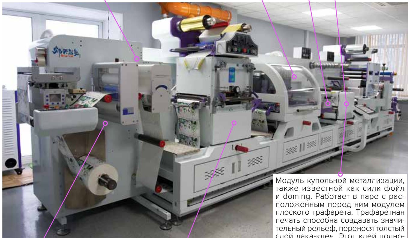
Модуль размотки. Снабжён пневмовалом, модулем выравнивания полотна, столом для срачивания материала при замене рулона и узлами очистки и обработки коронным разрядом
