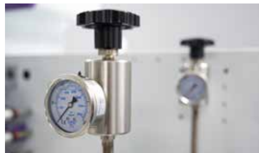
Микрометры системы GapMaster предназначены для настройки полуротационной высечки. При правильной настройке полностью прорезается материал запечатанного слоя, а несущий лайнер остаётся неповреждённым
