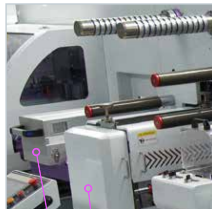
УФ-сушка и блок фольги для купольной металлизации (справа)
